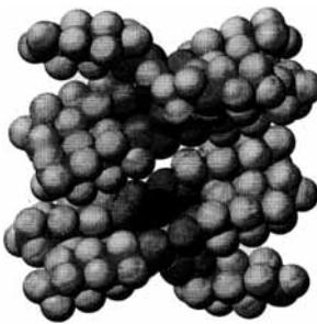
**Thermisch sehr stabil (bis 350 °C)** ist das supramolekulare mesogene Polyamid, das durch Selbstorganisation bei der Komplexbildung zwischen einem Nylon mit Pyridineinheiten im Rückgrat und einer Phenylbenzoësäure entsteht. Die vermutliche Struktur des wasserstoffbrückengebundenen Komplexes ist rechts schematisch gezeigt.
